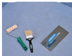
3 / Pripravíme si náradie – valček, štetec, oceľové hladítko.
