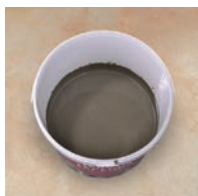
7 / Dôkladná homogenizácia oboch zložiek.
