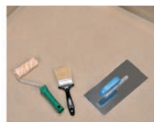
3 / Pripravíme si náradie – valček, štetec, oceľové hladítko.
