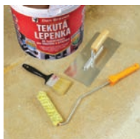
8 / Pripravíme si náradie – valček, štetec, oceľové hladítko.
